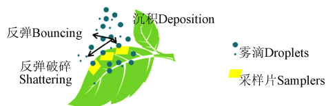
图 2 雾滴在采样面上的形态及运动轨迹变化情况 (包括粘附、反弹和破碎) [57]
