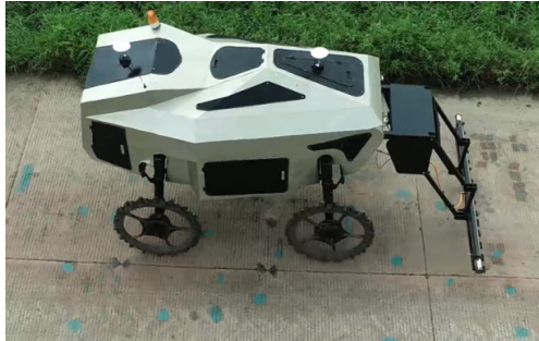
图7 对靶喷施模拟测试
