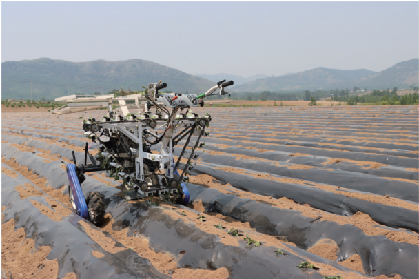
图 10 丘陵山地仿形扦插甘薯移栽机田间试验
