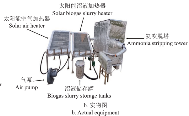
图 1 太阳能耦合氨吹脱装置示意及实物图
